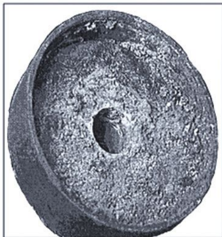
Рис. 1. Засорение механическими примесями ступеней УЭЦН (ОАО «Томскнефть»)
