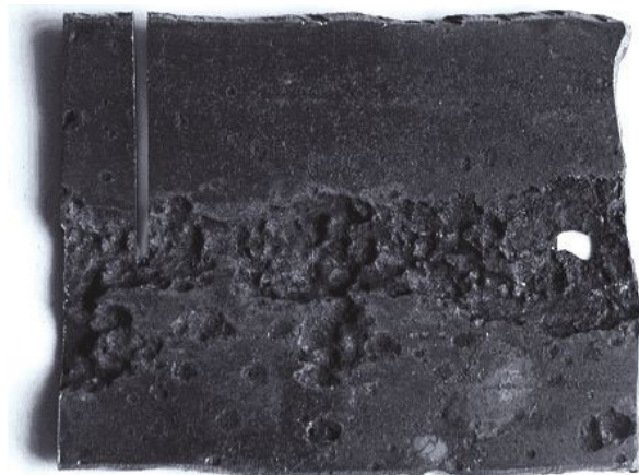
Рис. 4. Образец трубы с язвенной коррозией (Южно-Ягунское месторождение)
